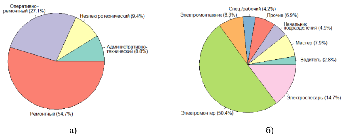
Рисунок 7 – Круговые диаграммы с распределением количества пострадавших в несчастных случаях за период 2011-2020 гг. (а - по виду категории персонала, б – по профессиям)
